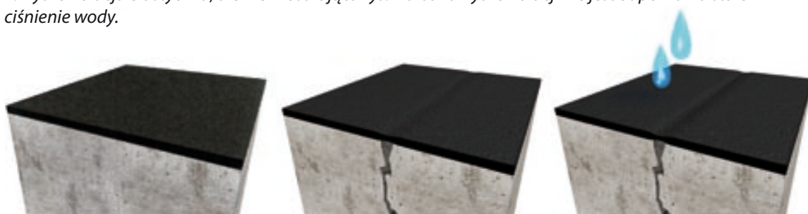
2. Hydroizolacja mostkująca rysy: w tym przypadku dzięki elastyczności i odpowiedniej grubości warstwy. Warstwa hydroizolacji jest odporna na stały napór wody.
