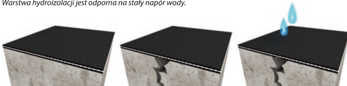
3. Mostkowanie rys dzięki zatopieniu siatki zbrojącej. Zbrojenie zabezpiecza górną warstwę izolacji przed pękaniem, zwiększając tym samym odporność powłoki na wodę pod ciśnieniem.
