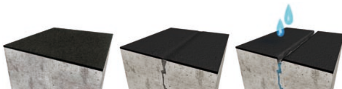
1. Hydroizolacja elastyczna, ale nie mostkująca rys: warstwa hydroizolacji nie jest odporna na stałe ciśnienie wody.
