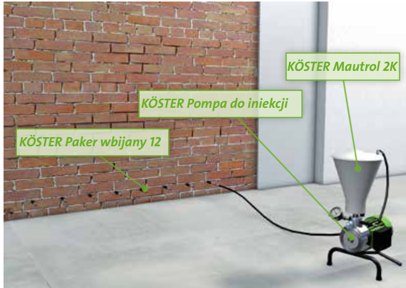
Wywiercić otwory w odstępach 10-15 cm na głębokość do 5cm mniejszą niż grubość muru
